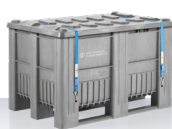
CB1 | 470 L 4H2/Y438/S/./D/BAM 15814-CR ① 1200 x 800 x 740 mm ② 1236 x 836 x 765 mm Masse brute max. : 437,5 kg Couleurs standard : ■
